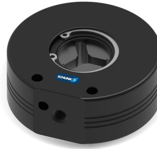
Mit den neu entwickelten Spannvorrichtungen TRIBOS-SVP Mini und TRIBOS-SVP RM lassen sich in Sekundenschnelle Werkzeuge wechseln. Spannvorrichtung auf TRIBOS-Mini oder TRIBOS-RM aufsetzen, Werkzeug einfügen, auf Anschlag spannen – fertig. Dank des voreingestellten Drucks ist das Werkzeug schnell und prozesssicher gespannt. Das spart Zeit und reduziert die Rüstkosten deutlich.
