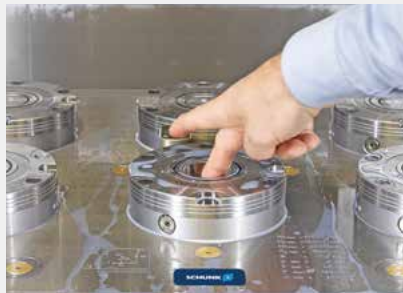
Merkmal des NSE3-Moduls ist ein optionaler, federbetätigter Konusverschluss, der die Wechselschnittstelle der Module automatisch verriegelt, sobald der Spannbolzen ausgehoben wird.
