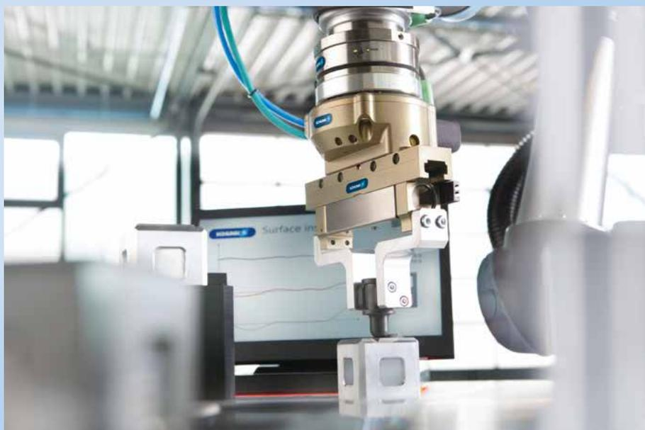
Abhängig von den Werkstücken und Prozessen können verschiedene Prüf- und Messverfahren automatisiert werden. Qualitätsprüfung und -sicherung dienen der Sicherstellung der Produktqualität während der Produktion. Handhabungs- und Sensorik-Komponenten ermöglichen die automatisierte Qualitätsprüfung und unterstützen bei der Dokumentation der Mess- und Prüfwerte.
