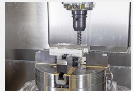
Mit dem Vier-Backen-Handspannfutter ROTA-M flex 2+2 vereint SCHUNK die Vorteile und Funktionen von Zwei-, Drei- und Vier-Backenfuttern in der Werkstückbearbeitung. Bild: SCHUNK
