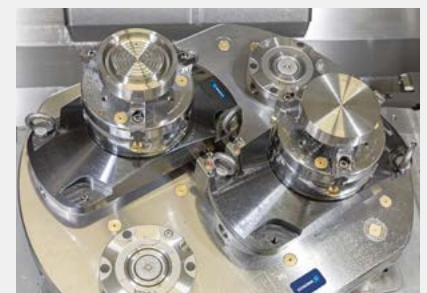
Auf der flexiblen Spannstation VERO-S lassen sich zwei Drehfutter ROTA-S plus 2.0 montieren und somit zwei verschiedene Werkstücke in einem Arbeitsgang in der Maschine bearbeiten. Bild: SCHUNK
