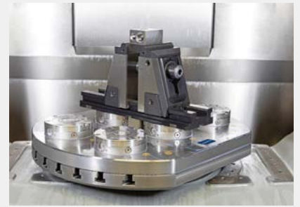
Der Fünf-Achs-Spanner KONTEC KSX-C2 lässt sich in Verbindung mit dem Nullpunktspannsystem VERO-S in Sekundenschnelle und mit maximaler Wiederholgenauigkeit auf den Maschinentisch einwechseln. Bild: SCHUNK
