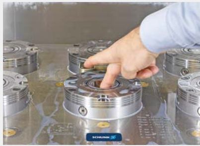
Merkmal des NSE3-Moduls ist ein optionaler, federbetätigter Konusverschluss, der die Wechselschnittstelle der Module automatisch verriegelt, sobald der Spannbolzen ausgehoben wird. Bild: SCHUNK
