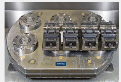
Aufspannung mehrerer Kleinteilspanner KSC 80 mit WIKA-Edelstahlbauteilen auf der VERO-S Spannstation. Bild: SCHUNK
